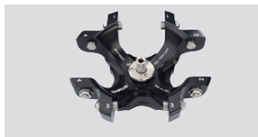
Бакетный ротор, герметизируемый, 4 × 100 мл Макс. скорость 4000 об/мин. Макс. ОЦУ 2486 × g. Радиус 40 мм. № по каталогу: 30314823. Автоматическое распознавание ротора.
