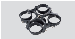
Бакетный ротор, 4 × 100 мл Макс. скорость 4500 об/мин. Макс. ОЦУ 3350 × g. Радиус 46 мм. № по каталогу: 30314822. Автоматическое распознавание ротора.
