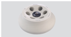
Угловой ротор, 6 × 50 мл Макс. скорость 6000 об/мин. Макс. ОЦУ 4427 × g. Радиус 29 мм. № по каталогу: 30314830. Автоматическое распознавание ротора.
