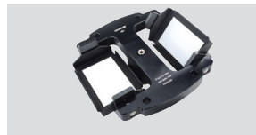
Бакетный ротор, 2 × 3 микропланшета Макс. скорость 4500 об/мин. Макс. ОЦУ 2716 × g. Радиус 11 мм. № по каталогу: 30314824 Автоматическое распознавание ротора.
