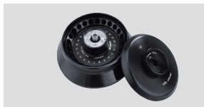
Угловой ротор, BIOSEALS, 24 × 1,5/2,0 мл V1 Макс. скорость 14 000 об/мин. Макс. ОЦУ 18 624 × g. Радиус 11 мм. № по каталогу: 30642361. Автоматическое распознавание ротора.
